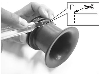
3. 切断面を紙ヤスリで平らにし、ファンネル内側に R5の丸みを持たせます。
