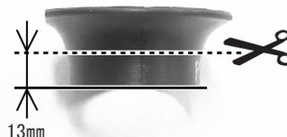
6. 切断面を紙ヤスリで平らにし、耐ガソリン性の接着剤で#2,3ファンネルの上部と下部を貼り付けます。
