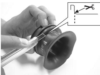
5. 切り取った#2,3ファンネルの上部を、右写真を参照し下から13mm短く切ります。
