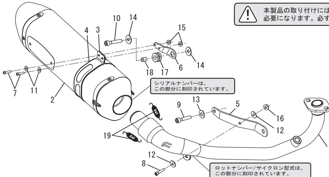
**!** 本製品の取り付けには、別途純正ガスケットが必要になります。必ず新品を用意して下さい。
