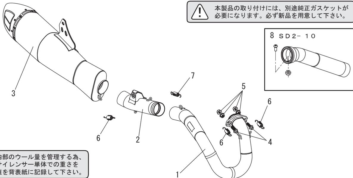
**!** サイレンサー内部のウール量を管理する為、取り付け前にサイレンサー単体での重さを測定し、測定値を背表紙に記録して下さい。
