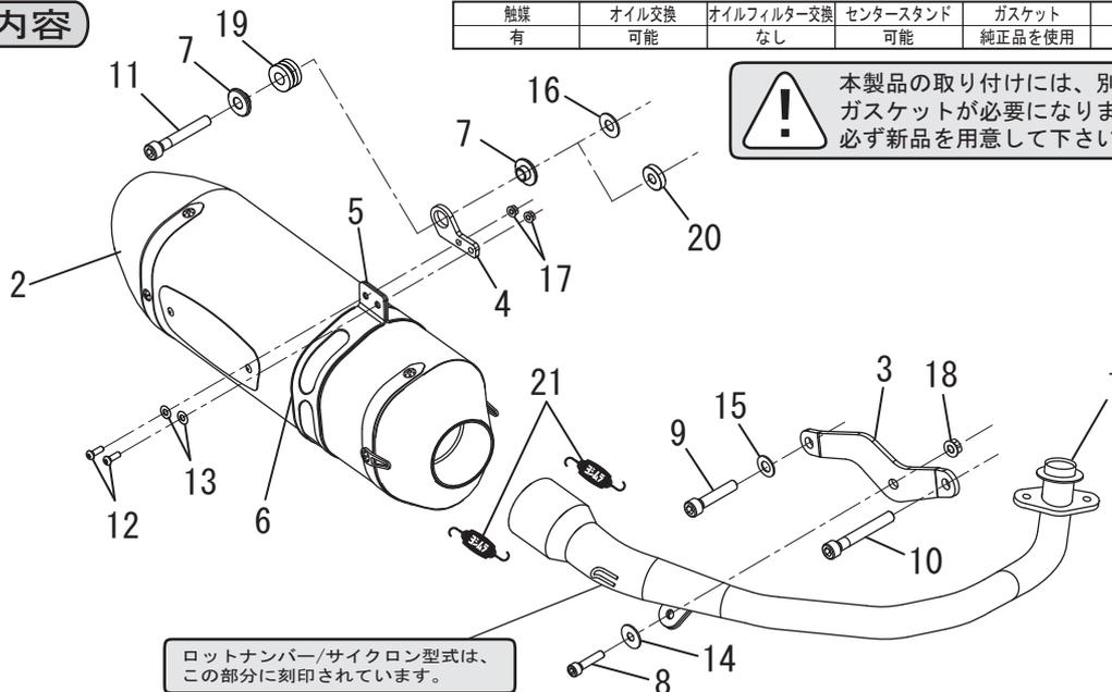
**!** 本製品の取り付けには、別途純正エキゾーストガスケットが必要になります。必ず新品を用意して下さい。
